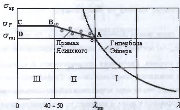
Рис.2.8. Зависимость критических напряжений от гибкости стержня для стали Ст.3.
