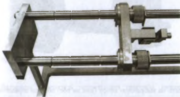
Рисунок 1.6. Установка подвижной плиты для длины рабочей зоны 300 мм
