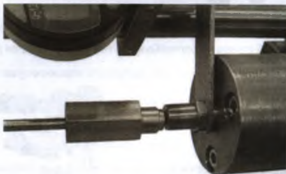
Рисунок 1.8. Установка ограничивающей втулки.
