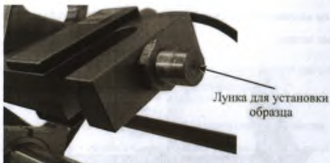
Рисунок 1.7. Опора для установки образца
