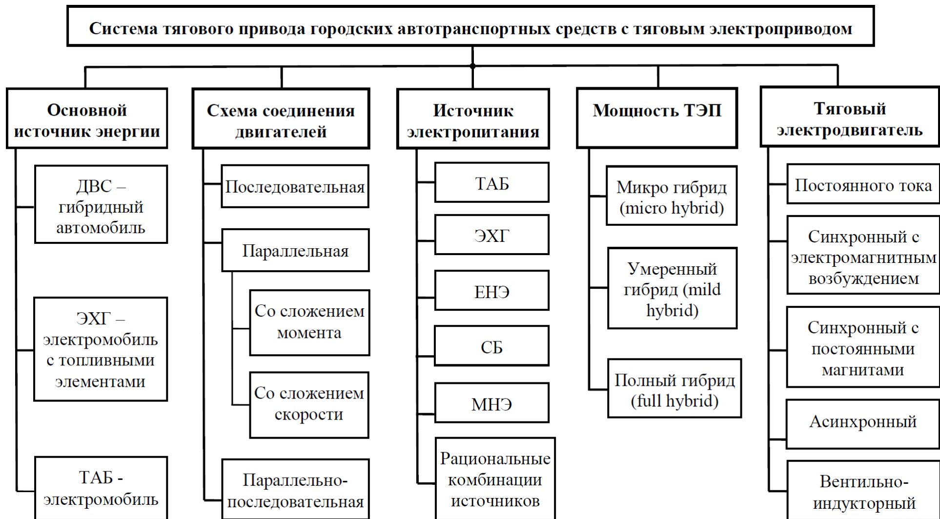
Рис. 1.1. Классификация систем тягового привода АТС с ТЭП
