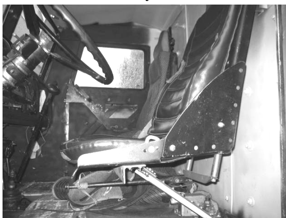
Рисунок 8 - Противоминное кресло, установленное в бронированном Урал-4320
