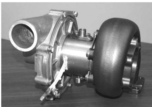
Рисунок 4 – Турбоэлектродвигатель (без охлаждения)
