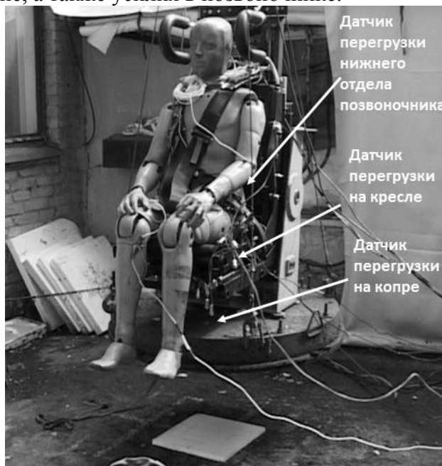
Рисунок 3 – Манекен «Гибрид-2» на стенде перед сбрасыванием
