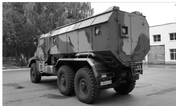
Рисунок 14 - Бронекорпус с V –образным днищем
