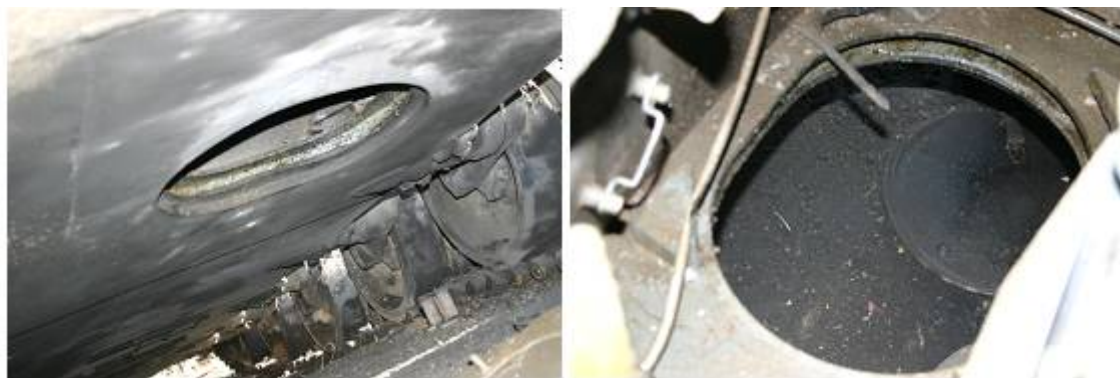
Рисунок 23 - Результат подрыва - обрыв узлов крепления люка
