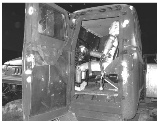
Рисунок 9 - Испытания противоминного кресла подрывом с использованием манекена
