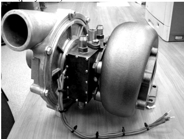
Рисунок 6 – Турбоэлектродвигатель (с охлаждением)
