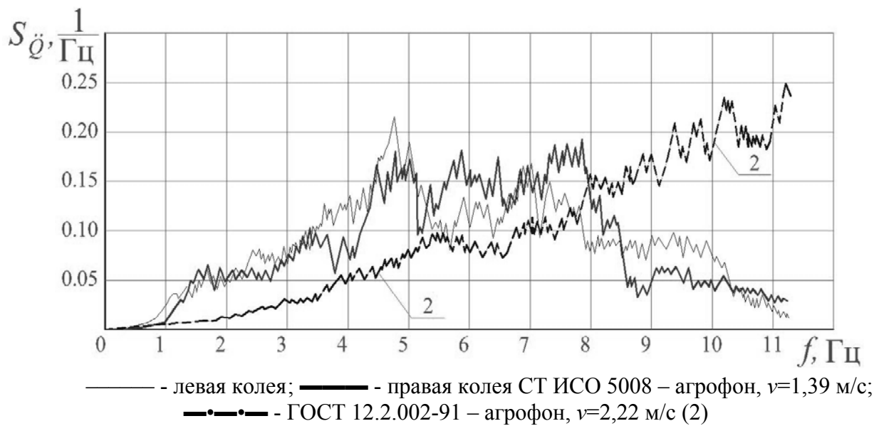
Рисунок 2 - Нормированные спектральные плотности воздействий по ускорениям от эталонных треков
