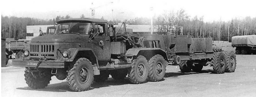
Рисунок 6 – Активный автопоезд ЗИЛ–137–137Б (10×10) с гидрообъемным приводом колес прицепного звена
